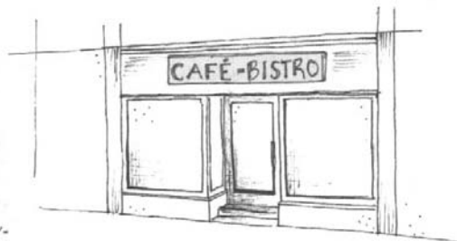
Enseigne posée à plat
