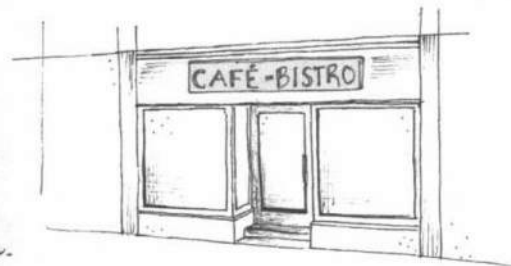
Enseigne posée à plat
